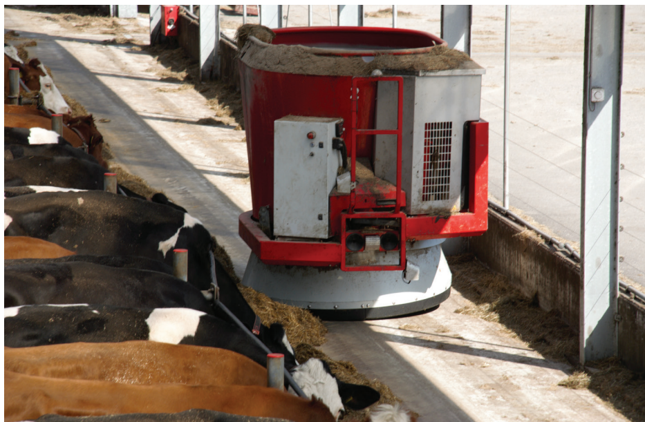
Foto. 3. Samosterujący robot do sporządzania i zadawania paszy w żywieniu TMR (J.Walczak)
